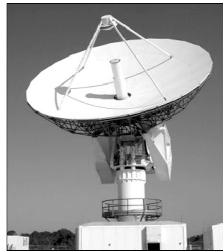
▲ FMCW 수신기가 장착 된 레이더의 모습
